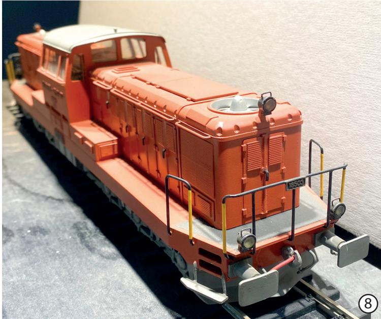
Die Loks erreichten eine Höchstgeschwindigkeit von 75 km/h. Die Lokomotiven stammen noch aus der Zeit, als die SLM die Schweizer Lokschmiede schlechthin und Sulzer noch weltweit bekannter Hersteller von Dieselmotoren waren.
