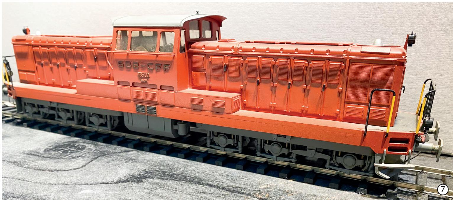
1954 wurden vorerst vier Prototypen der dieselektrischen Lokomotive abgeliefert. Ab 1960 folgte eine Serie von weiteren 10 Lokomotiven vom Typ Bm 6/6 für den Rangierdienst und Hilfs- und Arbeitszüge. Um die Loks im Teillastbetrieb energiesparend einsetzen zu können, lässt sich eine Antriebseinheit, bestehend aus einem Strom erzeugenden Sulzer-6LDA25-Dieselmotor (478 kW bei 850 U/min) und drei Elektromotoren für den Antrieb abschalten.
